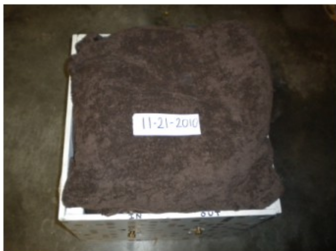
Caisson et stérilisateur en attente d'installation sur le capteur. La soupape et le manomètre seront découverts en temps utile, en fin de période de montée en température.
